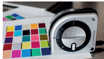
fig. 5 Le spectrophotomètre est l'outil de référence servant à mesurer les couleurs. Les derniers modèles sont très polyvalents et permettent de calibrer écrans, vidéo-projecteurs, imprimantes...
