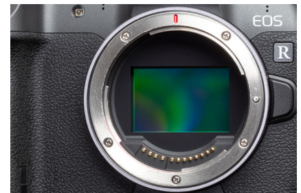
fig. 8 Le capteur est fragile et ne doit pas entrer en contact avec des éléments extérieurs: il faut toujours re-monter l'objectif sur le boîtier.
